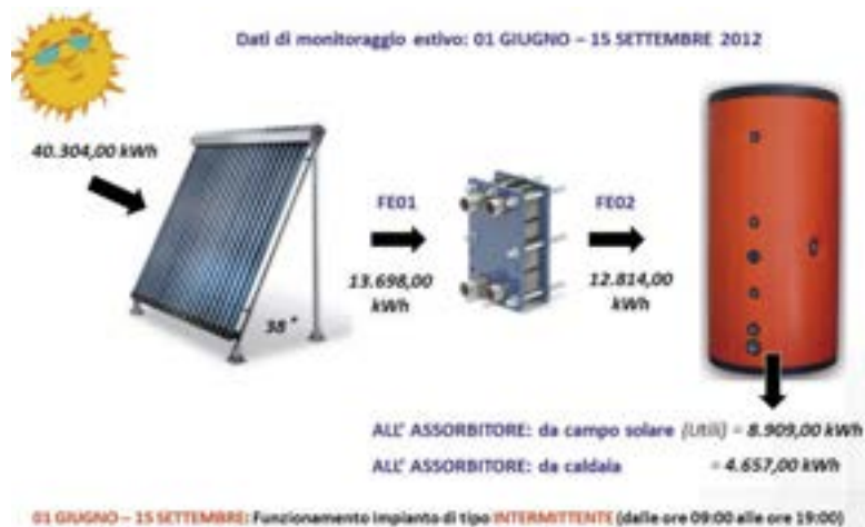
Figura 15 - Schema produzione e fornitura energia a partire dai collettori solari (estate)
