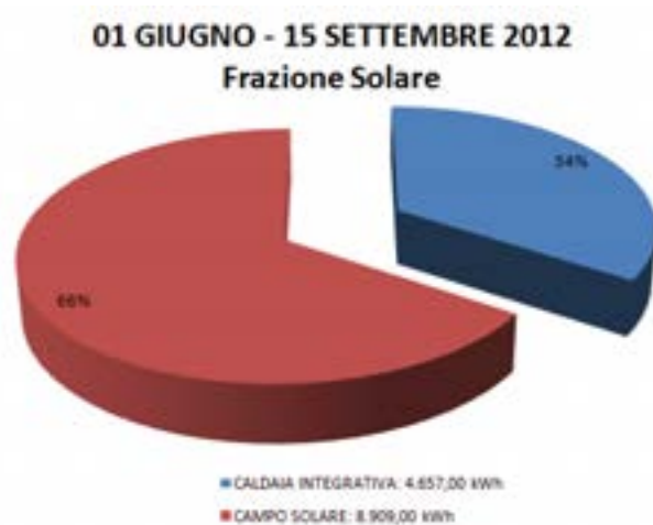
Figura 20 – Frazione solare impianto di solar cooling edificio F-92 C.R. ENEA di Casaccia
